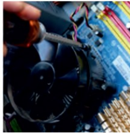
Fig. 1.42: Remove the system fan
