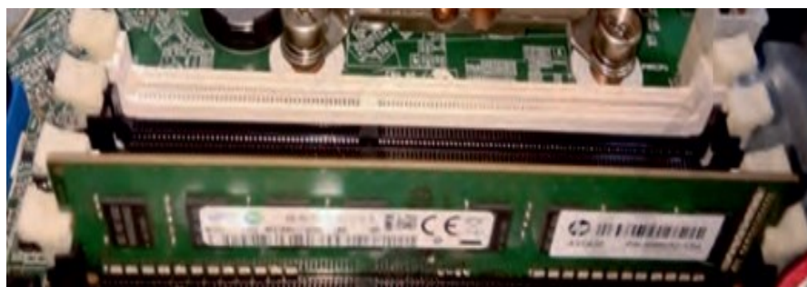
Fig. 3.13 Lock the RAM module
