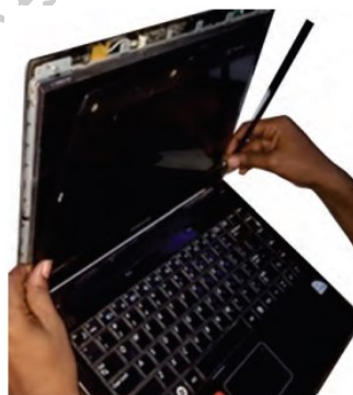
Fig. 2.23: Remove screen bezel
