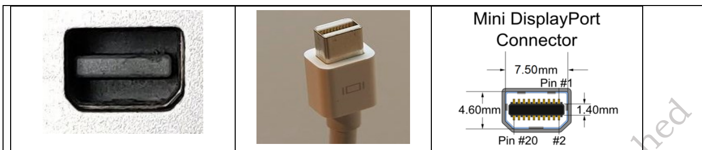
Fig. 1.43 Mini DisplayPort / Connector / Pinout diagram
