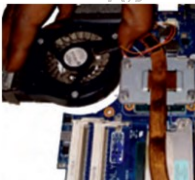
Fig. 2.14: Remove cooling fan
