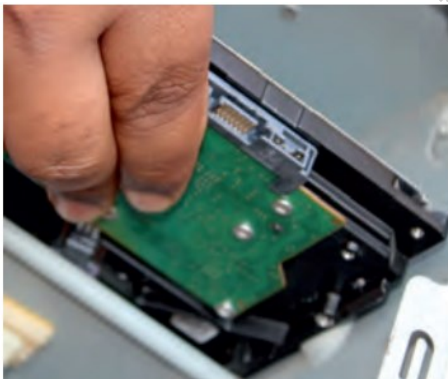
Fig. 1.12: Insert hard disk
